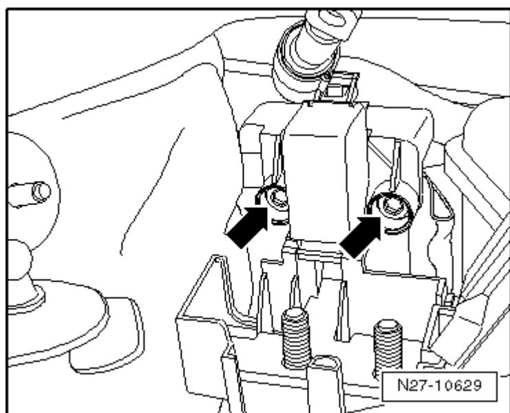
拧下液压油的备用油箱-1- 的紧固螺栓-2-，从支架上取下液压油的备用油箱-1-并将其与连接的软管放在一侧。
