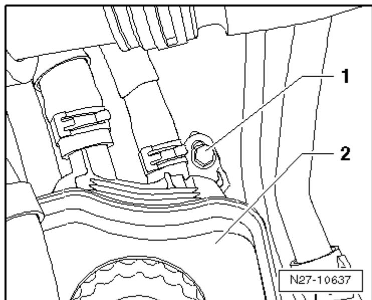
拧下紧固螺栓-1-和紧固螺母-3-，并从汽车上取下液压油的备用油箱和车外启动点的支架-2-。
